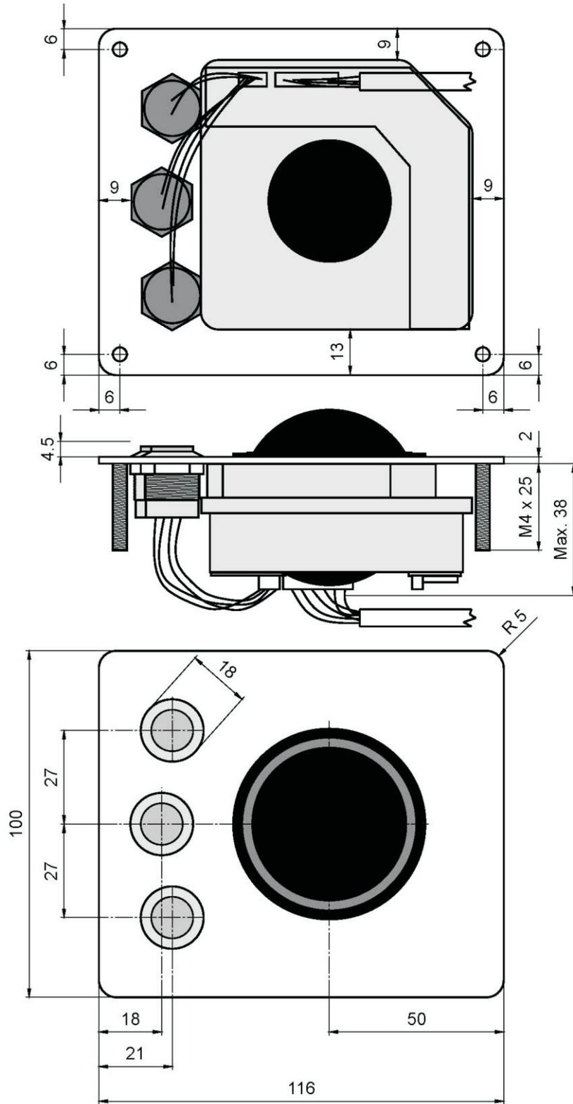
Der Kabelabgang der Schnittstelle befindet sich rechts unterhalb des Trackballmoduls
